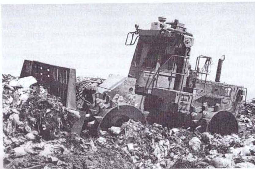
Slika 4. Kompaktor za zbijanje komunalnog otpada
